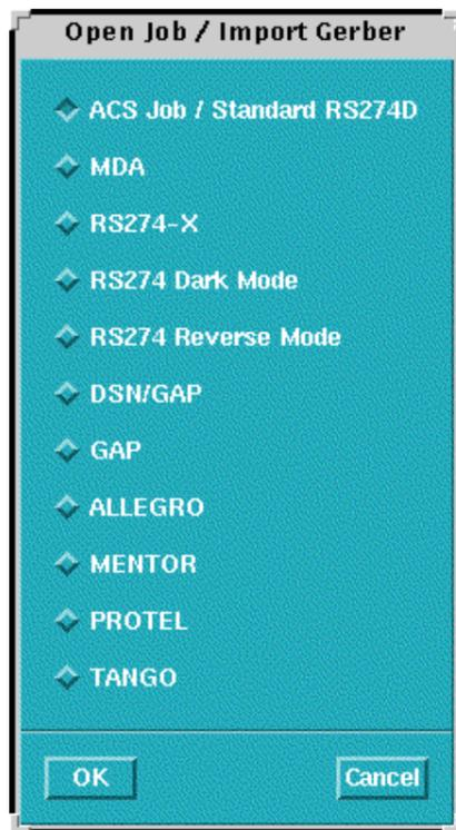
GBRVU をスタートすると、ロードする Gerber ファイルのタイプを入力するよう促されます。このシステムには、アパーチャ定義の入力の手間を省くために、代表的なアプリケーション用アパーチャ・トランスレータが用意されています。Gerber ファイルのソースを見分け、適当なアパーチャ・トランスレータがアクティブになります。
